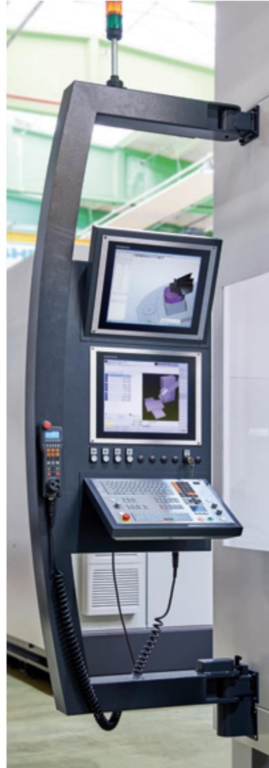
Bedientpult mit Steuerung, Heidenhain TNC 640
