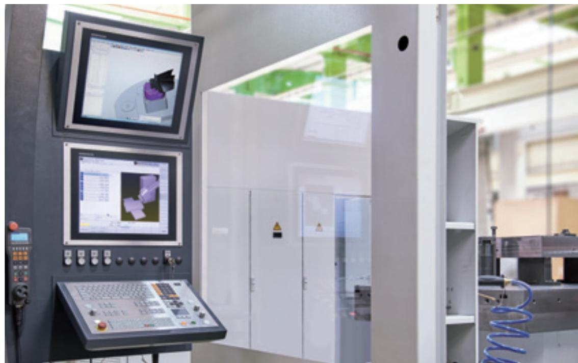
Bedienpult mit Steuerung, Heidenhain TNC 640 mit zusätzlichem Monitor
